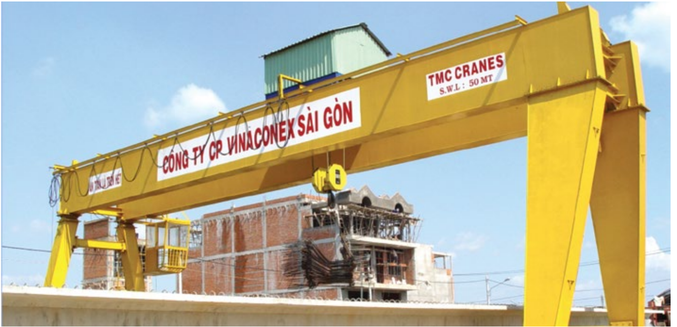
Cổng trục 50 tấn x Lk 18m, Long An 50-ton x 18m gantry crane, Long An Province
