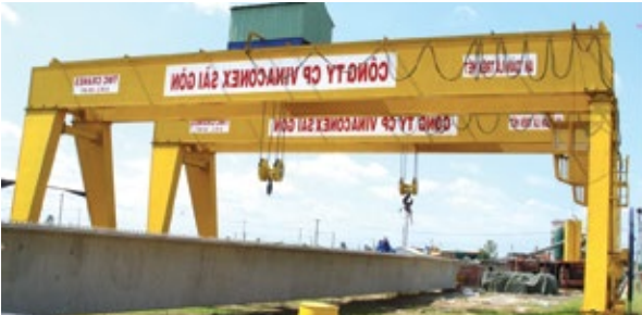
Cổng trục 50 tấn x Lk 18m, Long An 50-ton x 18m gantry crane, Long An Province
