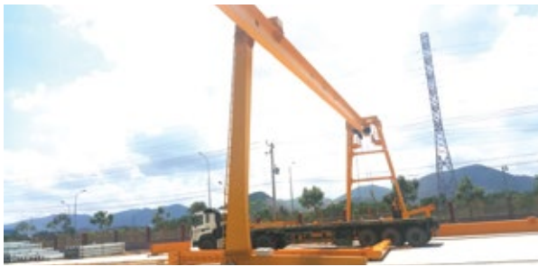
Cổng trục chữ C - 5 tấn x Lk 30m, Phú Mỹ - Bà Rịa 5-ton x 30m C-gantry crane, Phu My Town, Ba Ria - Vung Tau Province
