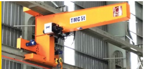
Cầu trục bờ tường 5 tấn x Lk 3m và cầu trục xoay 3.2 tấn x Lk 3m 5-ton x 3m jib crane and 3.2-ton x 3m rotary crane
