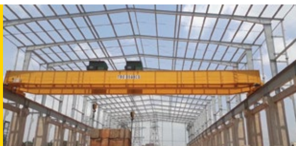
Cầu trục 50 tấn x Lk 27 m, Đắk Nông, Bình Phước 50-ton x 27m overhead crane, Dak Nong & Binh Phuoc Province
