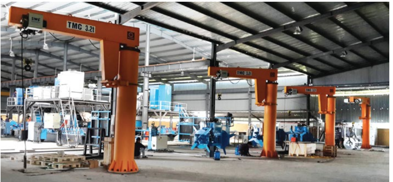
Cầu trục bờ tường 5 tấn x Lk 3m và cầu trục xoay 3.2 tấn x Lk 3m 5-ton x 3m jib crane and 3.2-ton x 3m rotary crane
