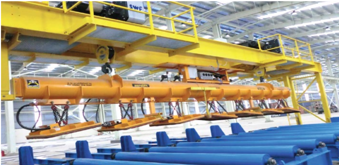
Cổng trục 25 tấn x Lk 16m, PV Pipe, Gò Công, Tiền Giang
